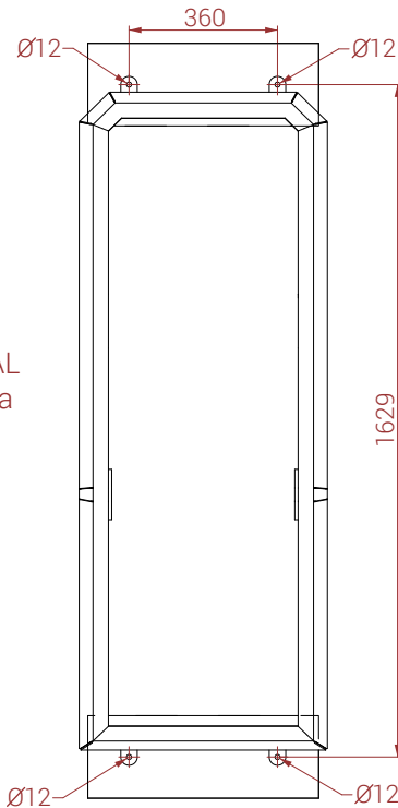
ROZSTAW OTWORÓW MONTAŻOWYCH
