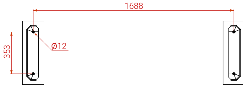
ROZSTAW OTWORÓW MONTAŻOWYCH (WIDOK Z GÓRY)
