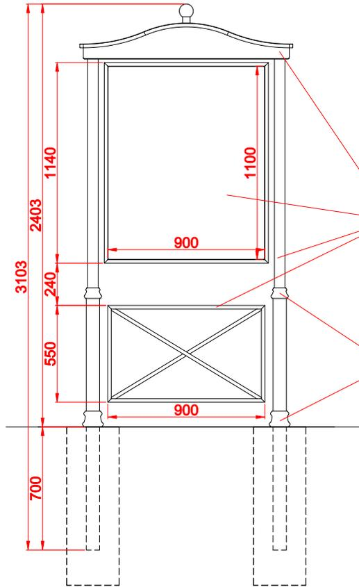
Acier de construction (S235JR, DC01) galvanisé et revêtu d'une peinture en poudre de couleur RAL
