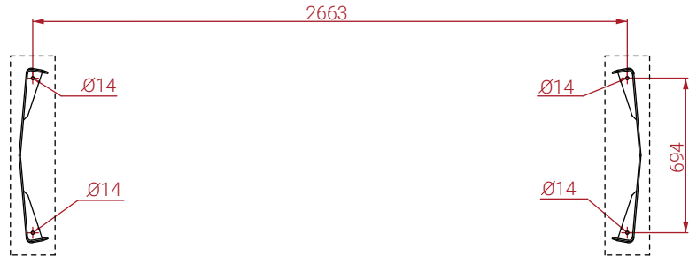
EROZSTAW OTWORÓW MONTAŻOWYCH (WIDOK Z GÓRY)
